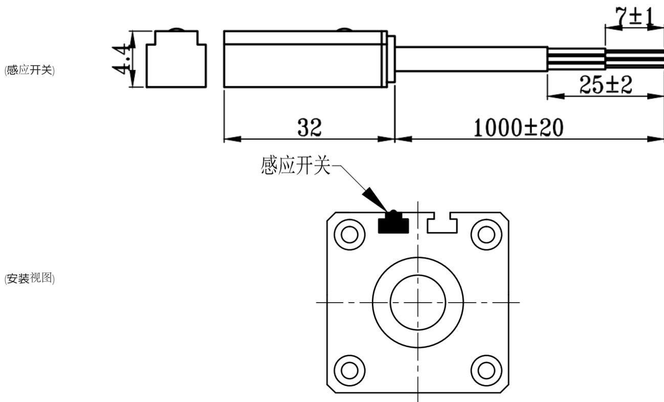
使用温度范围:-10°至70°,使用电压范围:5V-240V DC/AC,最大切换频率:200HZ
