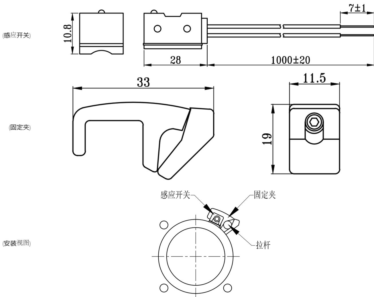
使用温度范围:-10°至70°,使用电压范围:5V-240V DC/AC,最大切换频率:200HZ
